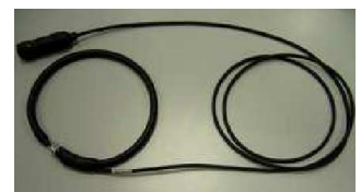
Anturi vaihetunnistusta varten keskellä kaapelia (oikosuljetut päät)
